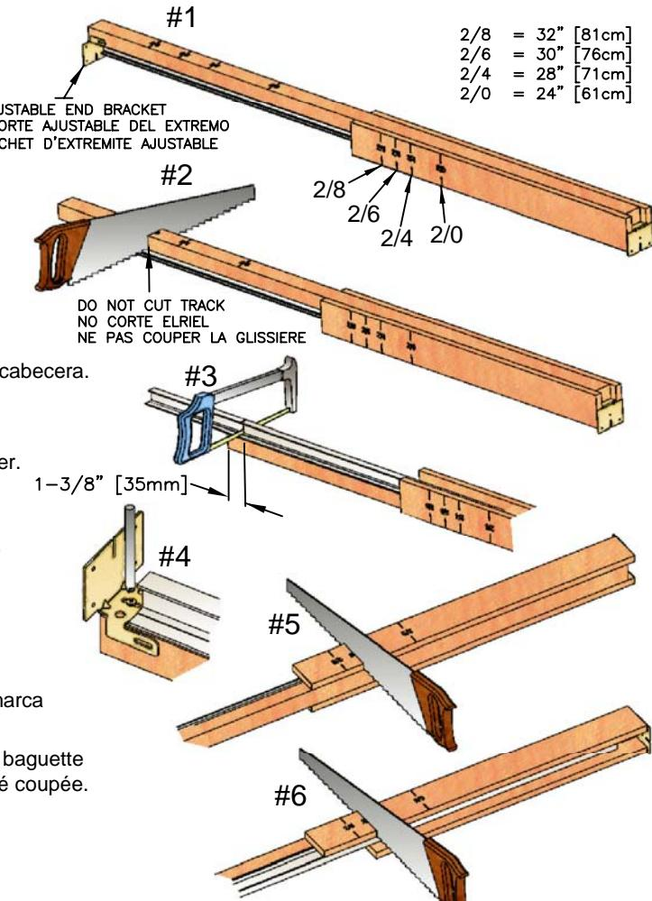
Para cortar la cabecera para puertas que no sean de un ancho estandar: Mida el ancho de la puerta y multipliquelo por 2. Súmelo 25mm. Marque la cabecera y córtelo (Paso #2). Corte el riel (Paso #3). Mida el ancho de la puerta. Súmelo 25mm. Marque la guía de la tabla del contramarco de la cabecera y córtelo (pasos #5 & #6).
